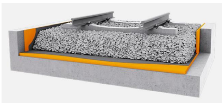
Figura 7 – Materassino antivibrante sotto-ballast (in arancione)
